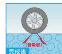
◆車両騒音が低減されるほか、雨天時における水しぶきやヘッドライトの路面反射が低減され運転者の視認性が向上します。(イメージ図参照)
