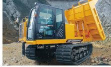
災害現場を想定した遠隔操作バックホウおよび自動走行クローラードンプ
