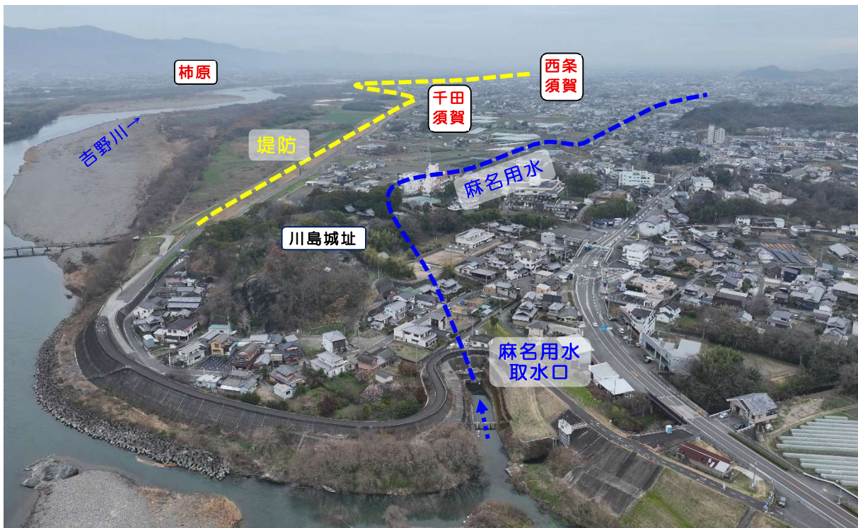
図 13 庄野太郎が構想を描いた川島城址下流の堤防と用水（現在の麻名用水）
