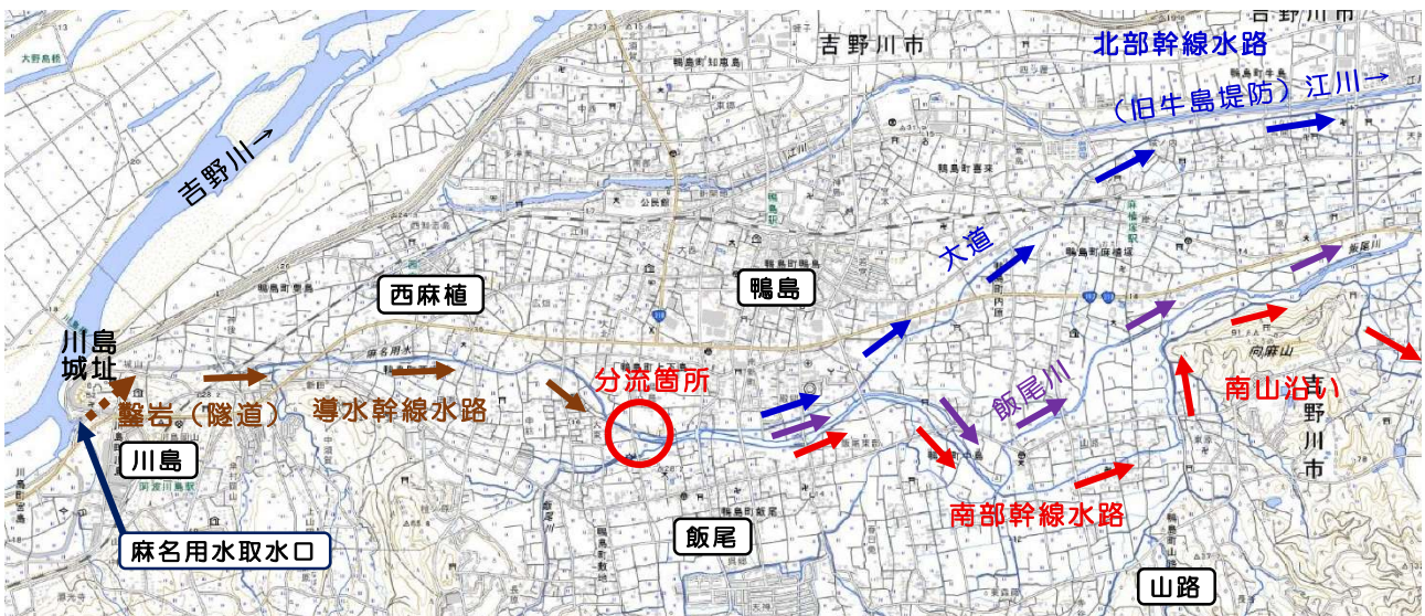
図 5 麻名用水取水口から用水分流状況（出典：地理院地図〔GIS MAP〕に筆者加筆）
