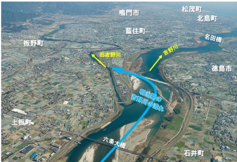
【写真2】今も、吉野川の水を北岸へと送る「第十堰」（第十堰から北へ「旧吉野川」が分派し、それが更に下流で「今切川」「撫養川」へ分派する）
