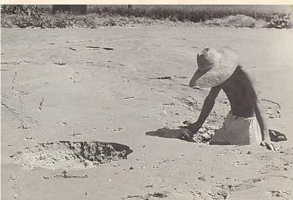
写真5 洪水が浸透してできた大穴(ガマ) (昭和 29 年9月ジューン台風)
