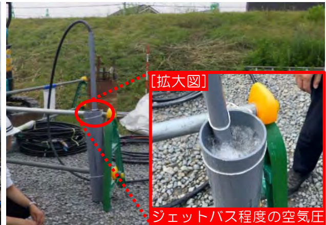
写真2：空気注入の模擬実演
