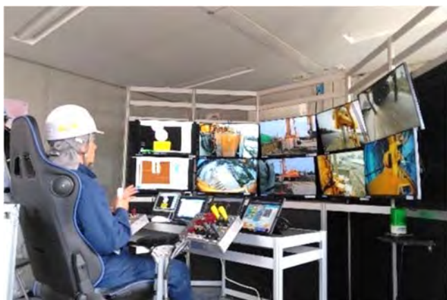
「日本初！」地盤改良機を自動制御して遠隔操作中！
