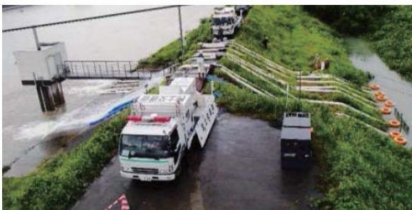
写真6.排水ポンプ車で排水をする様子
