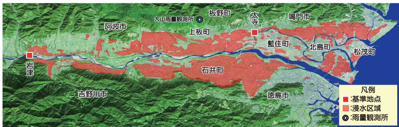
図9.平成16年10月洪水により浸水した範囲 吉野川下流(岩津～河口)
