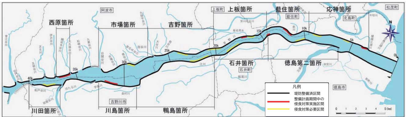
図 6. 浸食対策を実施する区間
