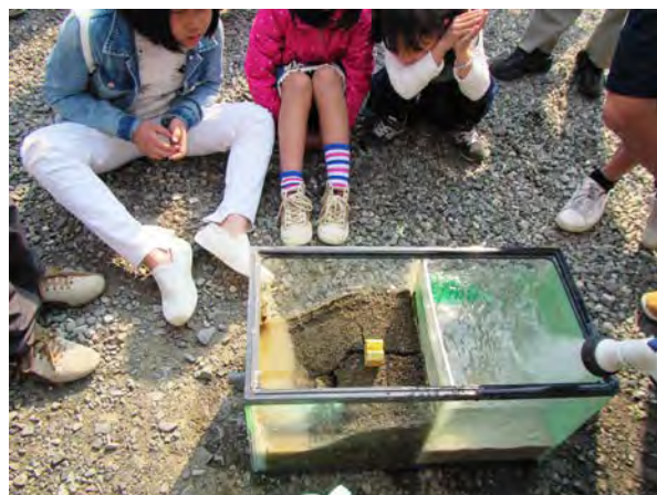
「漏水で堤防にひび割れが発生しました！」
