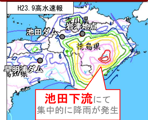
ダム下流で降雨が集中する場合 (平成23年9月洪水)
