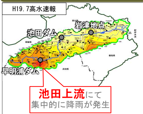
ダム上流で降雨が集中する場合 (平成19年7月洪水)
