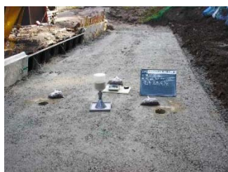
現場密度試験(砂置換法) ※品質管理基準 1回/500m 3
