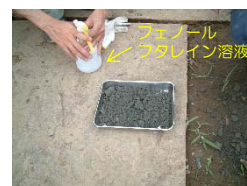
フェノールフタレイン溶液による確認 (品質管理基準 1日1回実施)
