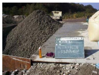
フェノールフタレイン溶液による確認 (品質管理基準 1日1回実施)
