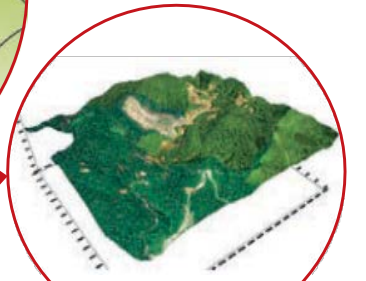
レーザー計測による河道閉塞周辺の計測
