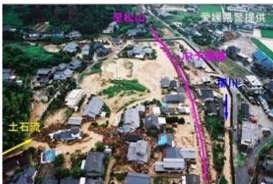
新居浜市楠崎地区（台風15号） 楠崎川からの土石流により人家全壊8戸、半壊3戸の被害が発生し住民1名が死亡、JR予讃線が埋没
