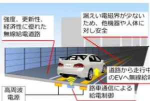
走行中給電施設
