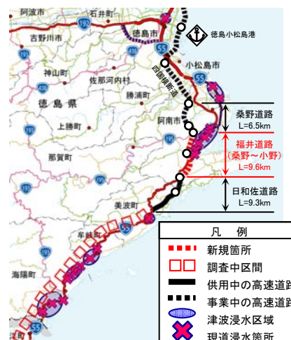
図2 津波浸水による分断箇所
