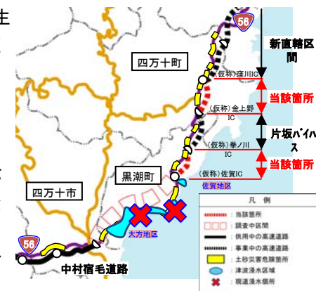
図2 国道56号浸水箇所想定と土砂災害危険箇所
