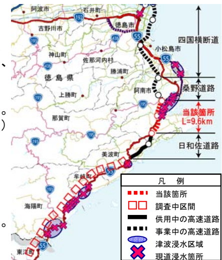
図2 国道55号浸水箇所想定図
