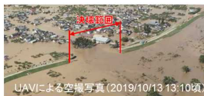
図-2 越水による決壊(千曲川)
