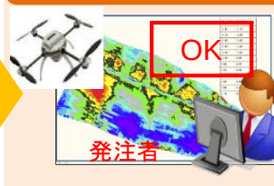
完成形状と3次元設計 データとの重ね合わせ
