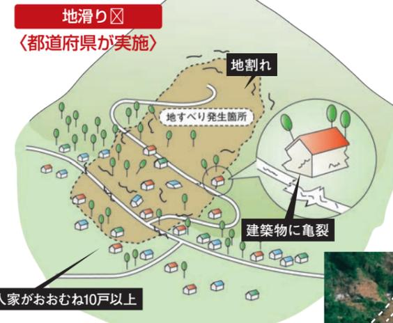
地滑りによる集落の被災例
