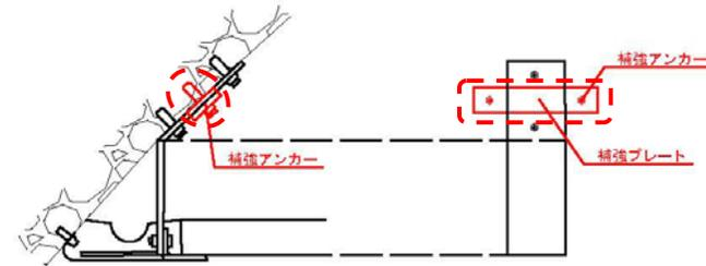
天井板吊金具補強イメージ (B部)
