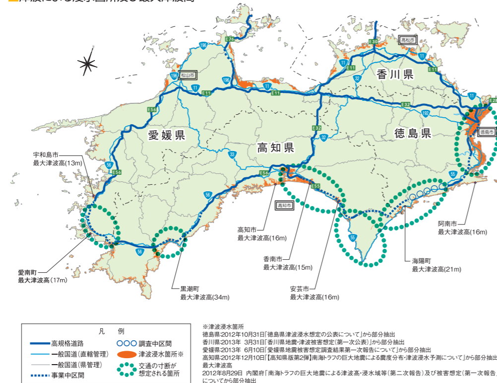
■津波による浸水箇所及び最大津波高
