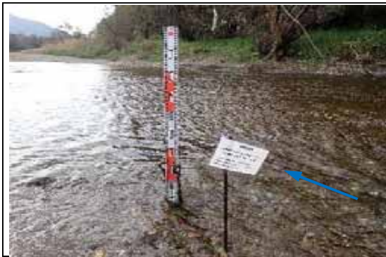
水位計設置状況（撤去前）
