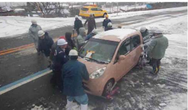
車両簡易移動器具を用いた車両移動
