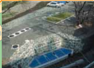
野村町山瀬川 (現地浄化実験施設) (植生接触酸化浄化方式)
