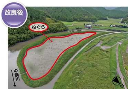
外敵侵入防止水路の掘削によるツル類のねぐらづくりの例(高知県中筋川)
