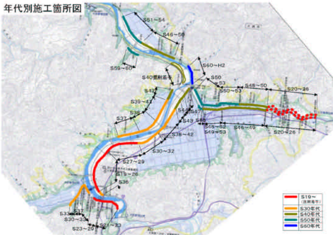
図 1.2.1 大洲盆地の堤防築堤の変遷図（矢印の間の数字は施工年度を示す）
