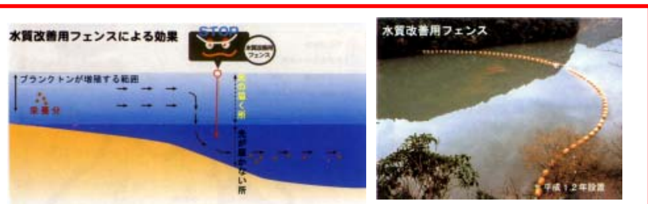
図2.2.7 プランクトンの大量発生を防ぐための水質改善用フェンスの設置（野村ダム）
