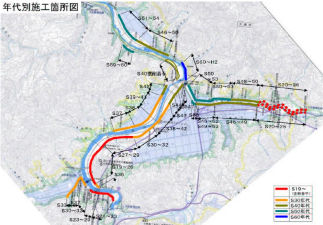
図 1.2.1 大洲平野周辺堤防築堤の変遷図（矢印の間の数字は施工年度を示す）
