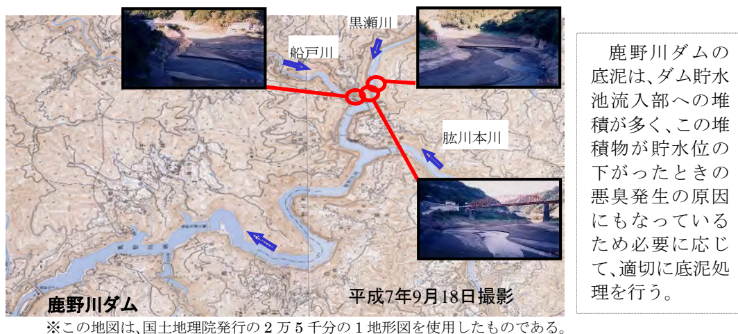
図 4.3.9 鹿野川ダム流入部の底泥堆積状況
