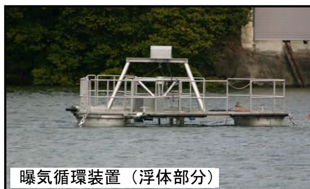
図 2.3.16 野村ダム水質保全対策実施例（曝気循環装置）
