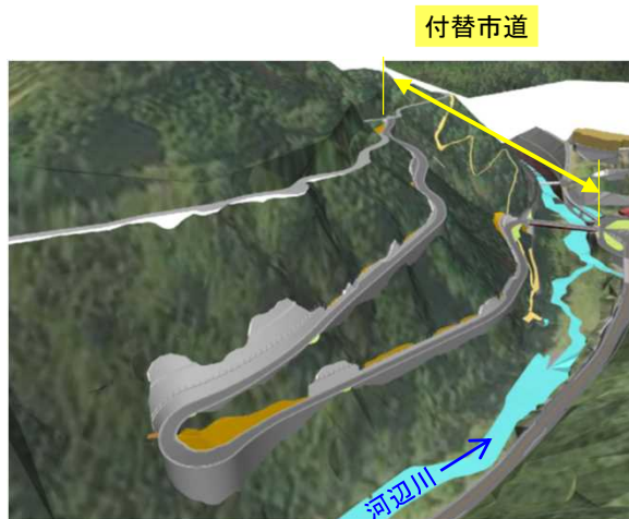
付替道路の盛土構造の変更(軽量盛土工)
