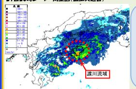
四国の南岸にのびた梅雨前線の影響で渡川流域に強い雨が 降いました。特に中筋川流域で強い降雨となり、山奈雨量観測 所で最大時間雨量28mm(21日19時~20時)、降り始めからの 総雨量は227mmを記録しました
