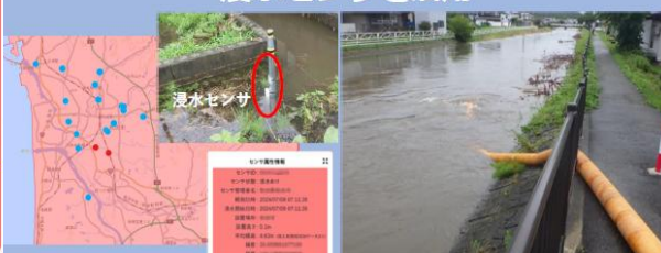
実証実験参加自治体：秋田県秋田市 (令和6年7月9日 浸水状況)
