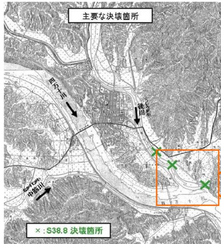
昭和38年8月洪水の破堤箇所
