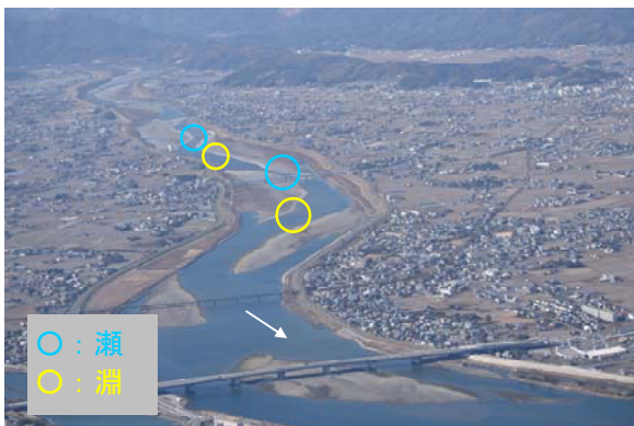
【瀬・淵の連続性（北岸堰下流）】
