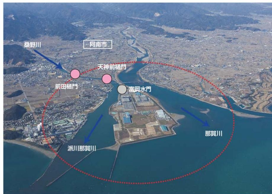
..... 堤防の嵩上げ・液状化対策    ○ 平成23年度迄 耐震化施工済み    ● 平成24年度 自動化・遠隔操作化実施箇所
