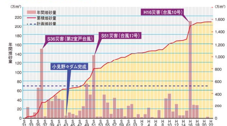
■長安口ダム堆砂量経年変化
