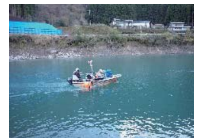
貯水池の定期縦横断測量
