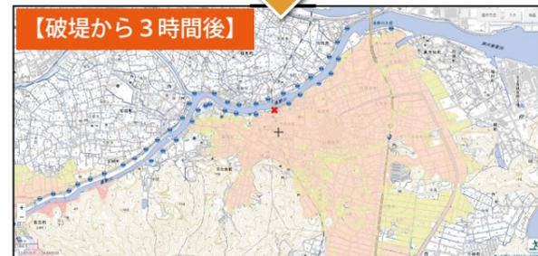
例：河口から4.0km右岸堤防が決壊した場合の浸水区域と浸水深
