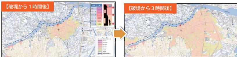
例：河口から4.0km右岸堤防が決壊した場合の浸水区域と浸水深
