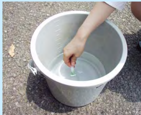
試薬入りチューブ(パ ックテスト)に水を吸い込む
