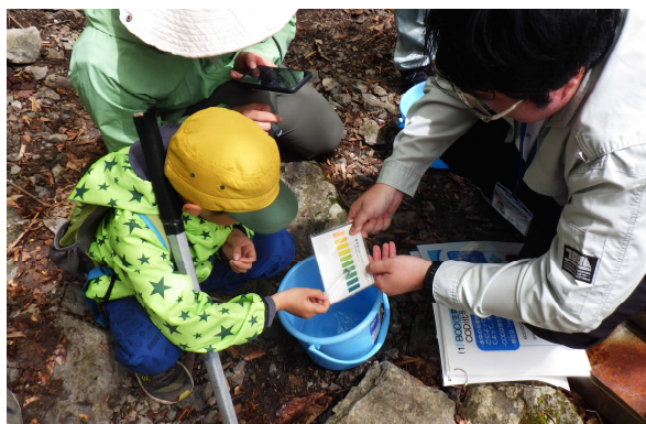
源流での簡易水質試験
