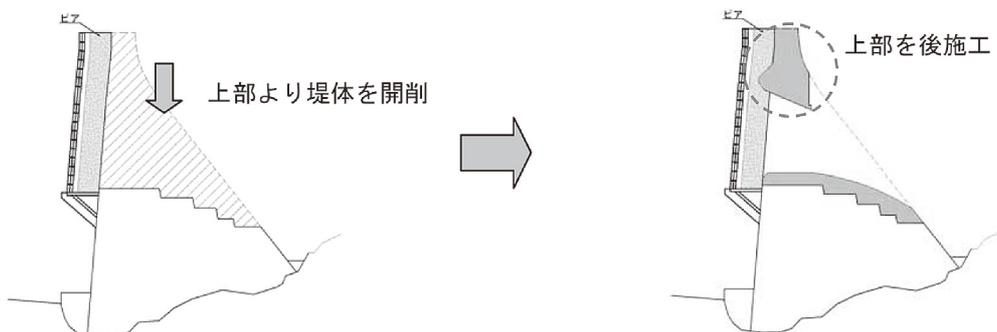
図4-9 オリフィス新設案の施工（上部より開削）
