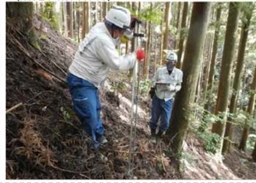
長谷川式土壌貫入試験の状況 (No. 24 R3. 10. 13)
