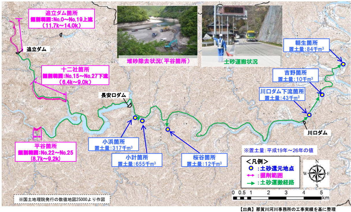
図 3-3 長安ロダム改造事業における堆砂対策の位置図
