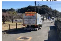
(空洞探査車による調査)
