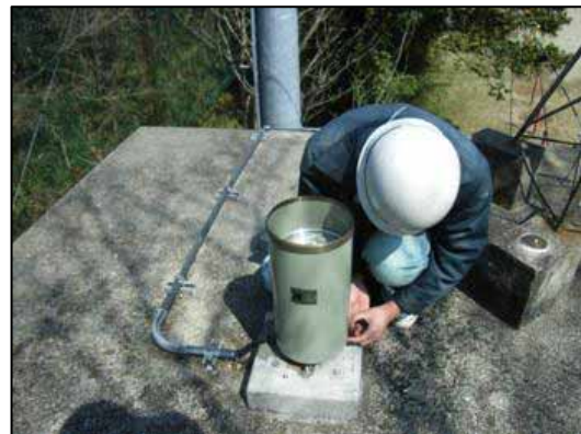
雨量観測施設点検状況
