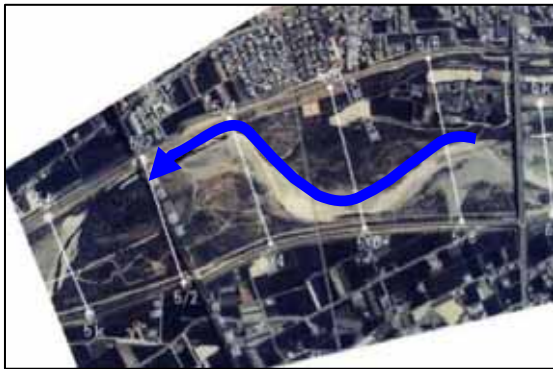
偏流の発生状況 (重信川 河口より 5.4km 付近松山市側)
