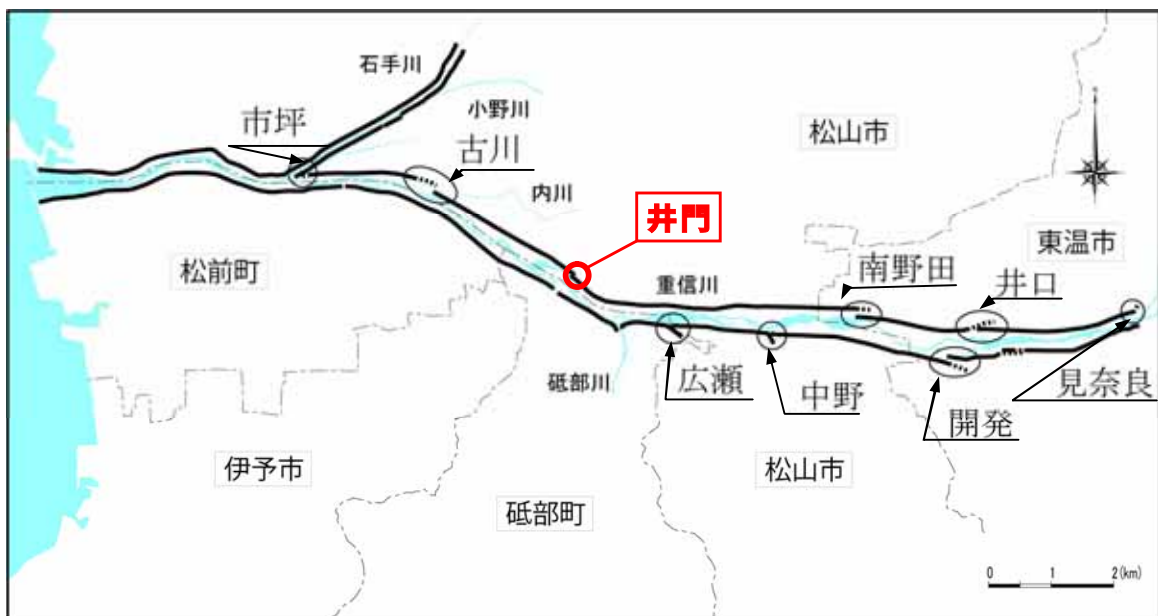
図-4.1.3 霞堤を整備する箇所
