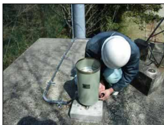
雨量観測施設点検状況
