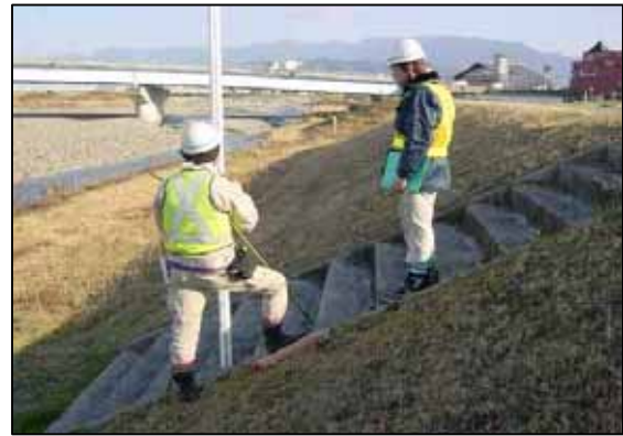
河川縦横断測量状況 (重信川 河口より8.7km 付近砥部町側)
