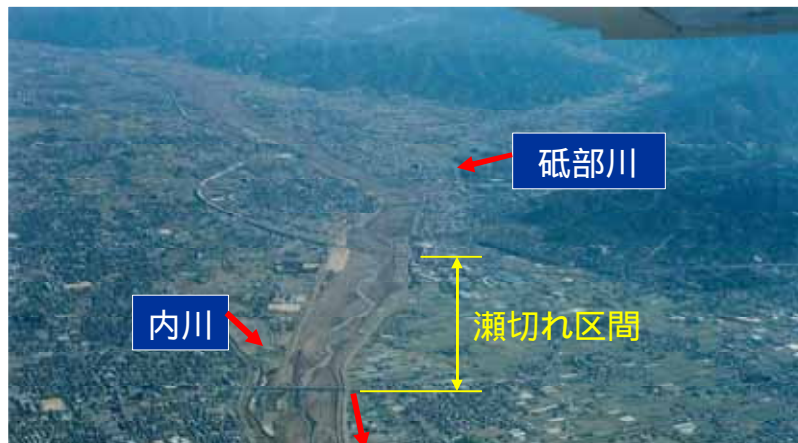
重信川 6k～8k 付近の瀬切れ状況（H14年12月撮影）
